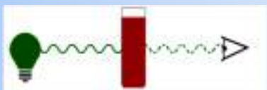
شکل ۱- نور سبز از طریق یک محلول قرمز تابانده می‌شود و میزان نور عبوری آشکارسازی می‌شود [۳]
