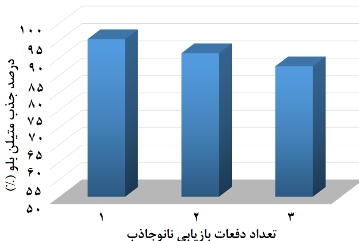
شکل ۸- بررسی قابلیت بازیابی نانوجاذب \text{Fe}_2\text{W}_{18}\text{Fe}_4/\text{FeTiO}_3 طی فرایند رنگزدایی جذبی
