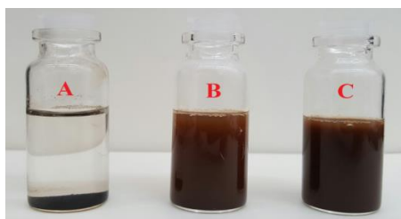
شکل ۲- تصاویر نانوذرات Fe_3O_4@PCA-b-PEG/Ni(0) (C) و Fe_3O_4@PCA-b-PEG (B) و Fe_3O_4@PCA-b-PEG/Ni(0) پراکنده شده در حلال آب بعد از یک
