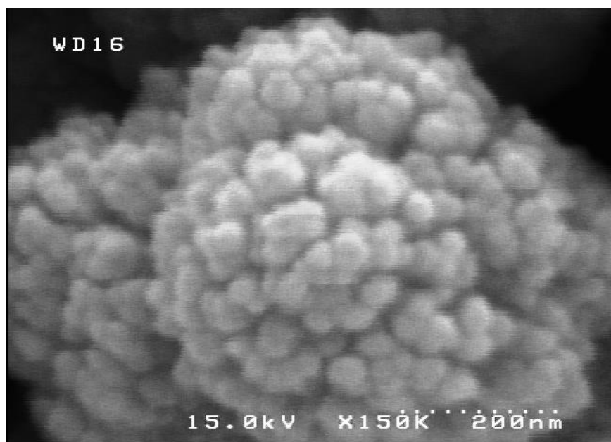
شکل ۲- تصاویر میکروسکوپ الکترونی روبشی و پراش اشعه ایکس کاتالیستهای آلیاژی سنتز شده
