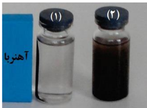
شکل ۳- خواص مغناطیسی سوسپانسیون کاتالیست را در حضور آهنربا (۱) و عدم حضور آهنربا (۲) را نشان میدهد.
