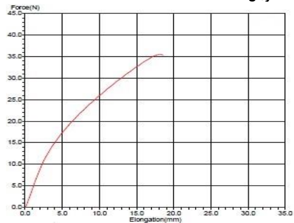
شکل ۲- منحنی تنش- کرنش نانوکامپوزیت حاوی ۱۵٪ پلی کاپرولاکتون و ۶٪ نانورس
